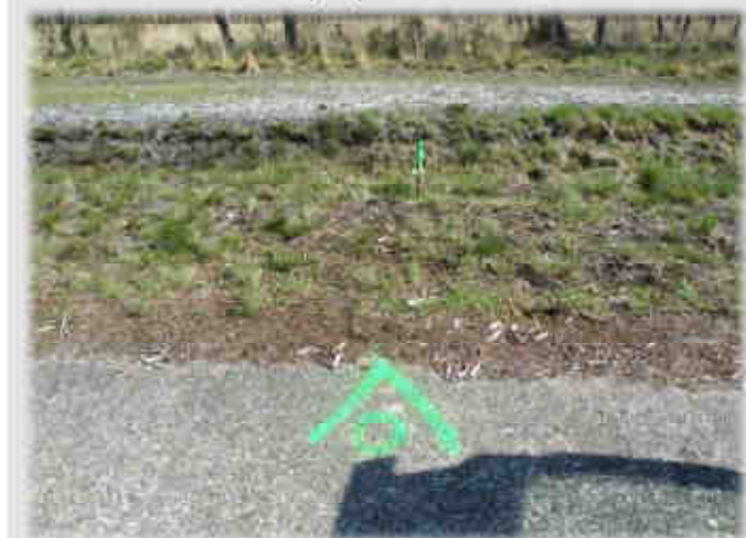
Chaque station a été repérée par un triangle vert avec un sigle «O», orienté vers un piquet en bordure du fossé, peint également en vert.
