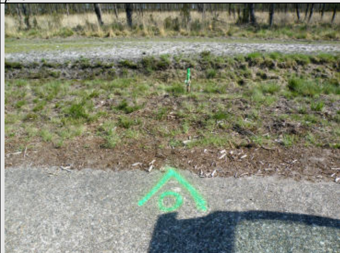
Chaque station a été repérée par un triangle vert avec un sigle « O », orienté vers un piquet en bordure du fossé, peint également en vert.
