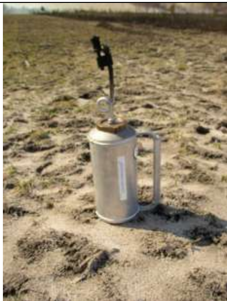
Appareil utilisé pour allumer le feu, contenant un mélange d'essence et de gazole.
